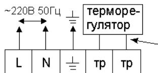
Для подключения терморегулятора необходимо снять перемычку и вместо неё подключить терморегулятор.
