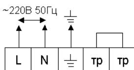
Схема подключения К5, К6 к электрической сети и терморегулятору.
