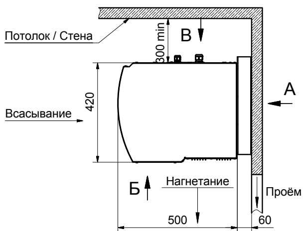
Рисунок 6. Габаритные и присоединительные размеры
